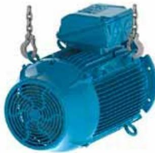
*Figura 4.19 – Resultado final: motor posicionado de forma horizontal.*
