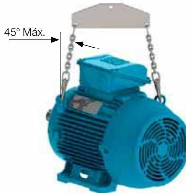
Figura 4.4 – Ángulo máximo resultante para motores con dos o más ojales de izamiento.
