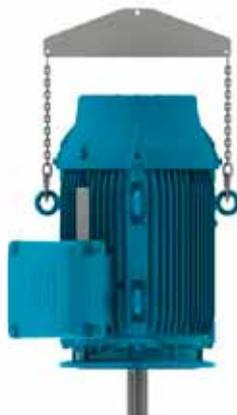
Figura 4.7 – Izamiento de motores verticales.
